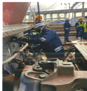
〈異常時対応訓練（電磁ブレーキ取扱）〉
